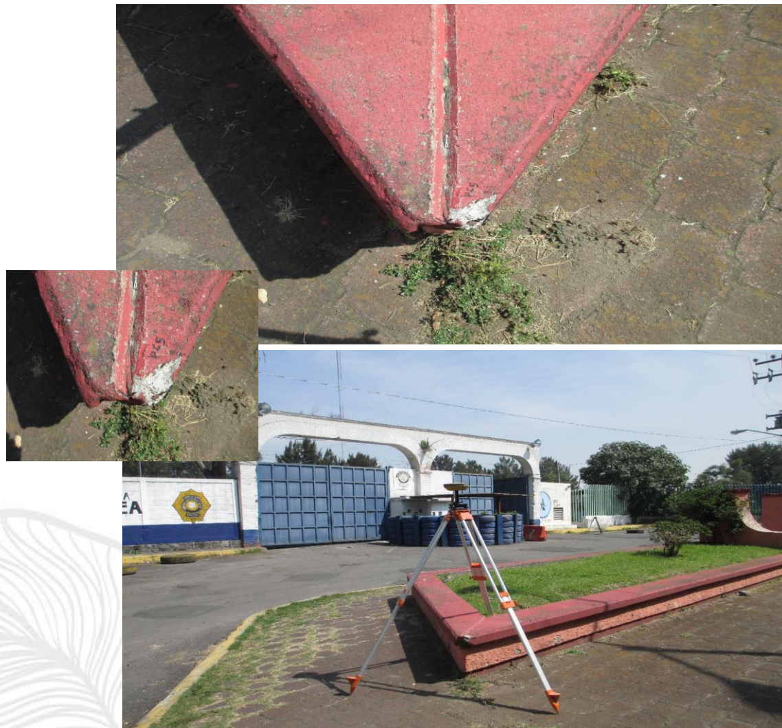
Figura 23. Coordenadas y detalle de la ubicación del PC-5 de la red de puntos de control del levantamiento LIDAR (Ligh Detection and Ranging), de la Licitación LA-909024988-N2-2014.
