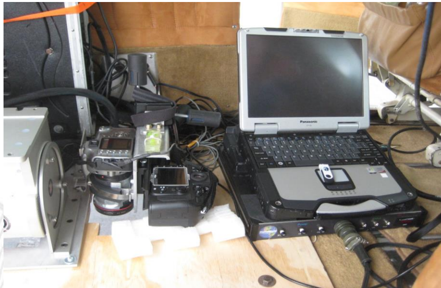
Figura 9. Montaje tipo de la consola de operación y control y cámaras digitales utilizadas para el levantamiento LIDAR (Ligth Detection and Ranging), especificado en la Licitación LA-909024988-N2-2014.
